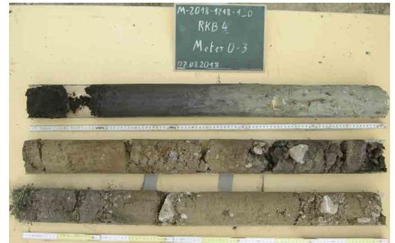
Linerrohre nach dem Öffnen
