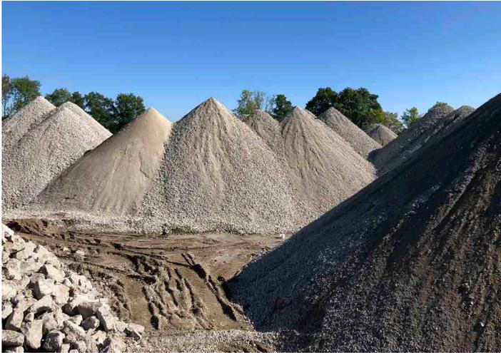
Aus Abbruchbeton wird ein qualitätsgeprüfter RC-Baustoff
