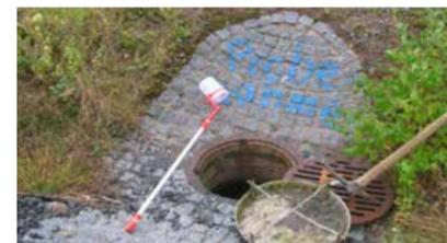
Durch Baumaßnahmen können Oberflächen und Grundwasser beeinflusst werden, sei es durch Schwankungen des Zuflusses (z. B. Grundwasserhaltung) oder Eintrag in Gewässer. Mittels hydrologischer Beweissicherungen können Grundwasserstände überwacht und die chemischen Parameter bestimmt werden, um bei negativen Beeinflussungen zeitnah Gegenmaßnahmen treffen zu können.
