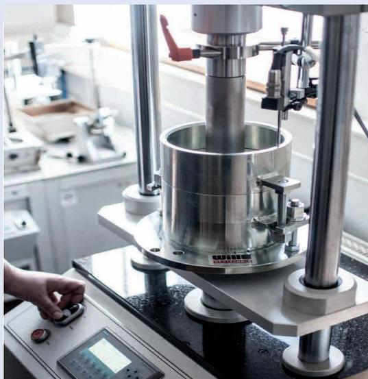
Durchführung eines CBR-Versuchs in der Universal-Press
