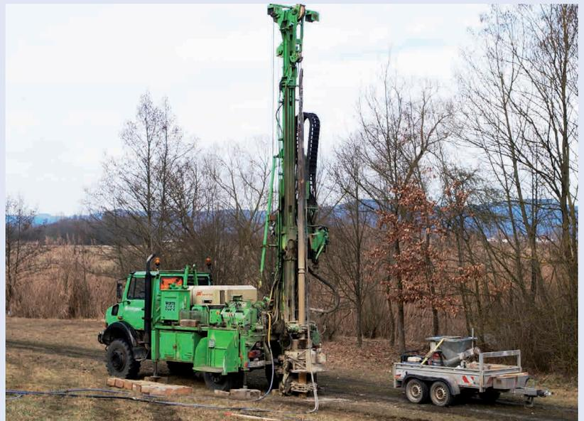
Trockenkernbohrgerät im Einsatz
