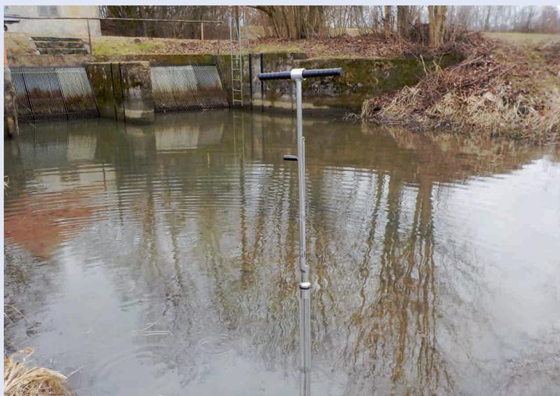
Sedimentprobenahme mit Multisampler
